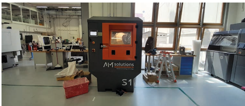
La macchina S1 serie 2 di AM Solutions è una soluzione multifunzionale: esegue la pulizia e la finitura superficiale in una sola unità indipendente
