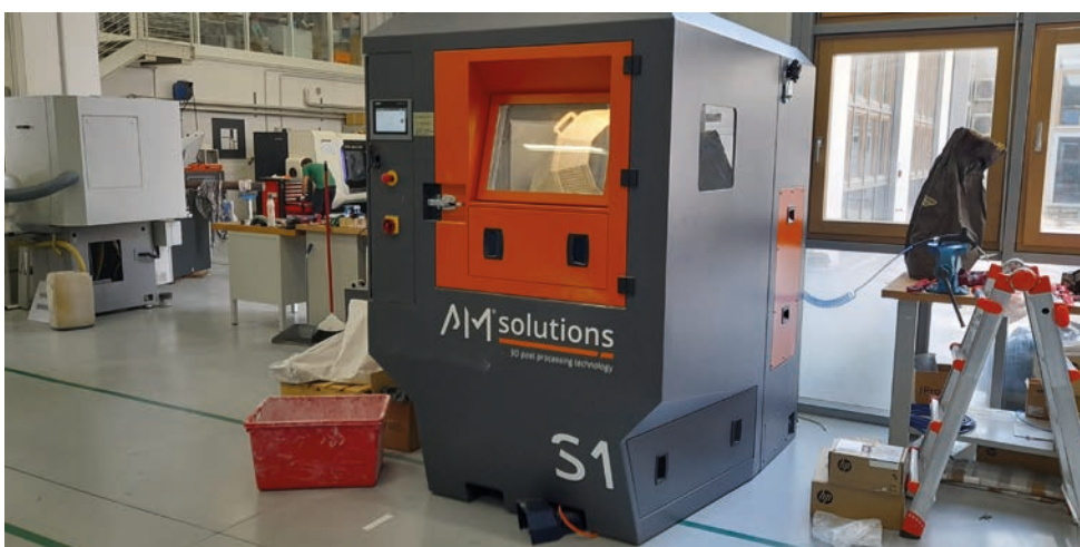
La S1 serie 2 separa al proprio interno la polvere di scarto dalla graniglia per garantire costante e omogeneo il processo
